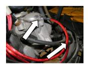
前点火コイルのアース部分 エンジンヘッドタペットキャップ にアーシング線を取付ます。
