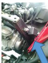
コントロールユニット本体取付位置は写真の場所に付属のボルトセットにて取り付ける。
