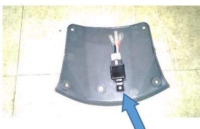
コントロールユニット本体取付位置は付属のボルトセットにて取り付けしてください。
